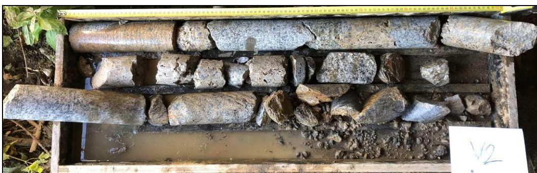
Obr. č. 4 – diagnostický vrt V2
